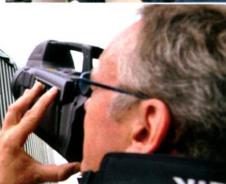
Spezialkamera zur Visualisierung schon kleiner Mengen von Methan und anderen flüchtigen organischen Kohlenwasserstoffen (VOC-Gasen) ein. Diese Gaskamera mit dem Namen „FLIR GF 320“ wurde vor kurzem in den USA zur Überwachung von Industrieanlagen- und Fernleitungen entwickelt.
